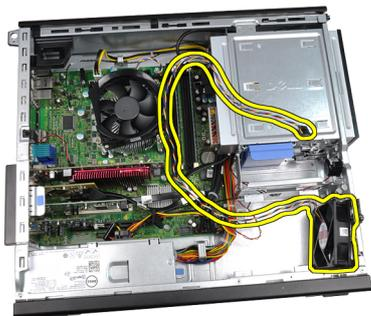
8. Saque los cuatro aros del ventilador del sistema.
