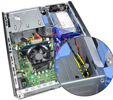
7. Saque el sensor térmico de la parte frontal del chasis.
