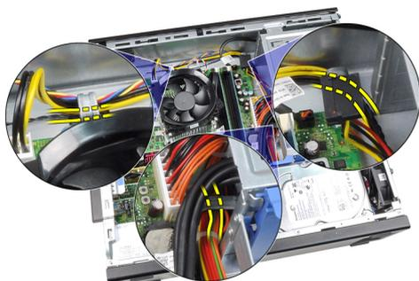
6. Saque el cable del sensor térmico del gancho del chasis.
