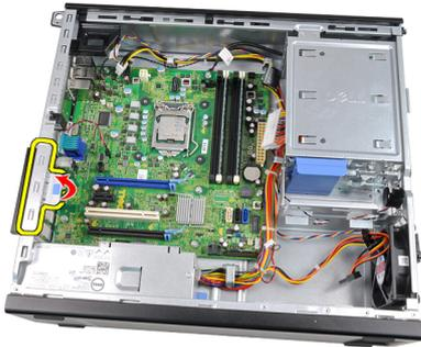
**9.** Retire los tornillos que fijan la placa base al chasis.
