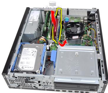
5. Deslice la tarjeta de expansión PCIe x1 (si la hay) para sacarla de su conector y extraerla del equipo.
