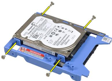
7. Doble el soporte de la unidad de disco duro y saque las dos unidades de 2,5 pulgadas del soporte.
