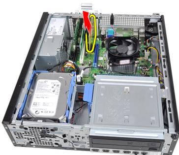
6. Deslice la tarjeta de expansión PCI (si la hay) para sacarla de su conector y extraerla del equipo.
