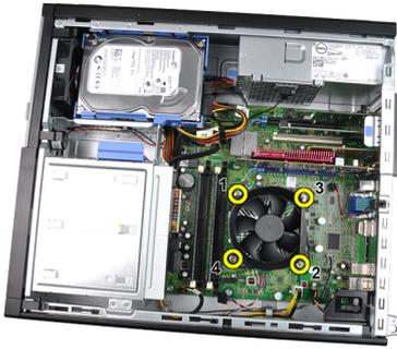
5. Levante el ensamblaje del disipador de calor y sáquelo del equipo. Apóyelo con el ventilador mirando hacia abajo y con la grasa térmica hacia arriba.
