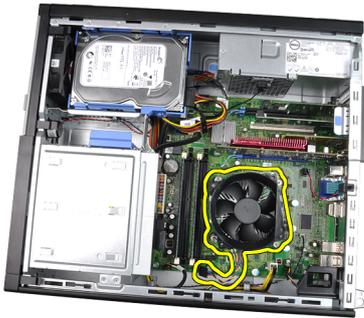
6. Presione la palanca de liberación y muévela hacia fuera para liberarla del gancho de retención que la mantiene fija.
