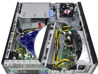
6. Desconecte el cable de alimentación de 24 patas de la placa base.
