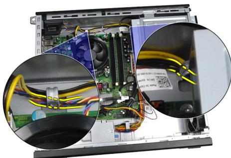
6. Deslice los cuatro aros hacia dentro y a través de las ranuras de la parte frontal del equipo.
