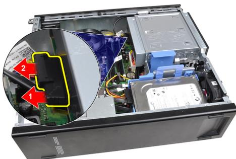
5. Deslice hacia arriba el pasador de la unidad óptica y presiónela de atrás hacia la parte frontal del equipo.
